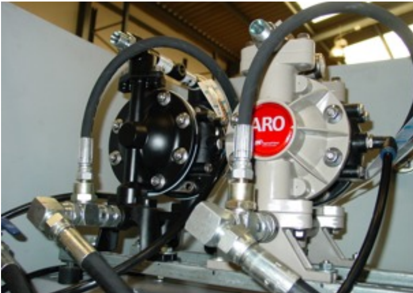
Bombas de diafragma de alta calidad específicas para cada fluido.
